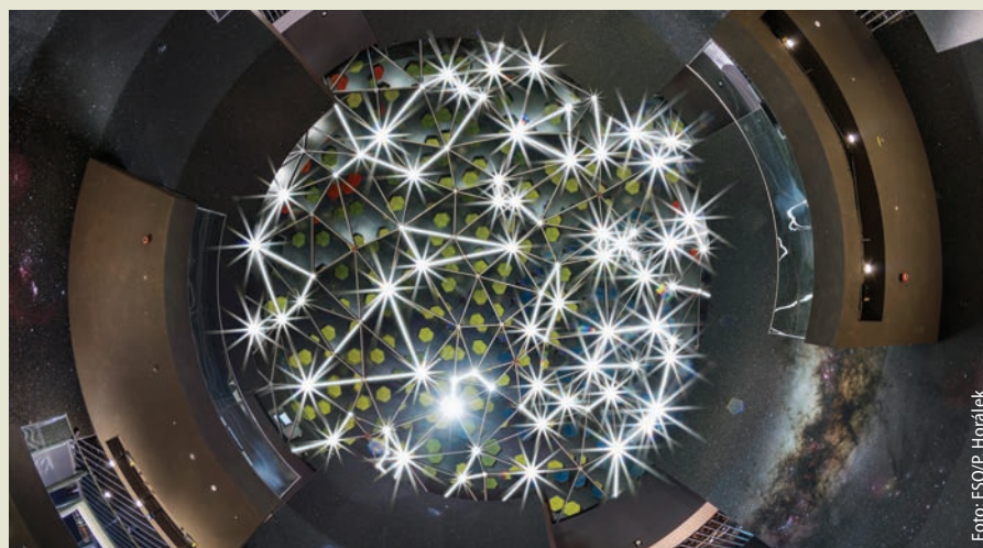
Sternenhimmel. Das verglaste Kuppeldach stellt mit seinen Profilstegen einen Teil des südlichen Sternenhimmels dar. Stege und Kreuzungspunkte können mit LEDs beleuchtet werden und Sternbilder darstellen.
